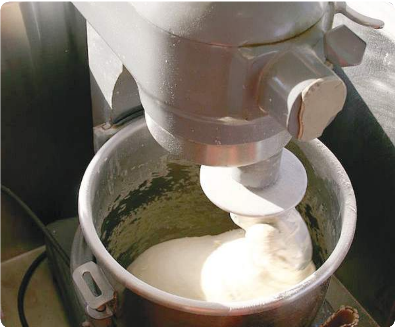
Commercial dough and batter mixer: බේකර් අයිතම සඳහා අමුද්‍රව්‍ය මිශ්‍ර කිරීම සඳහා
